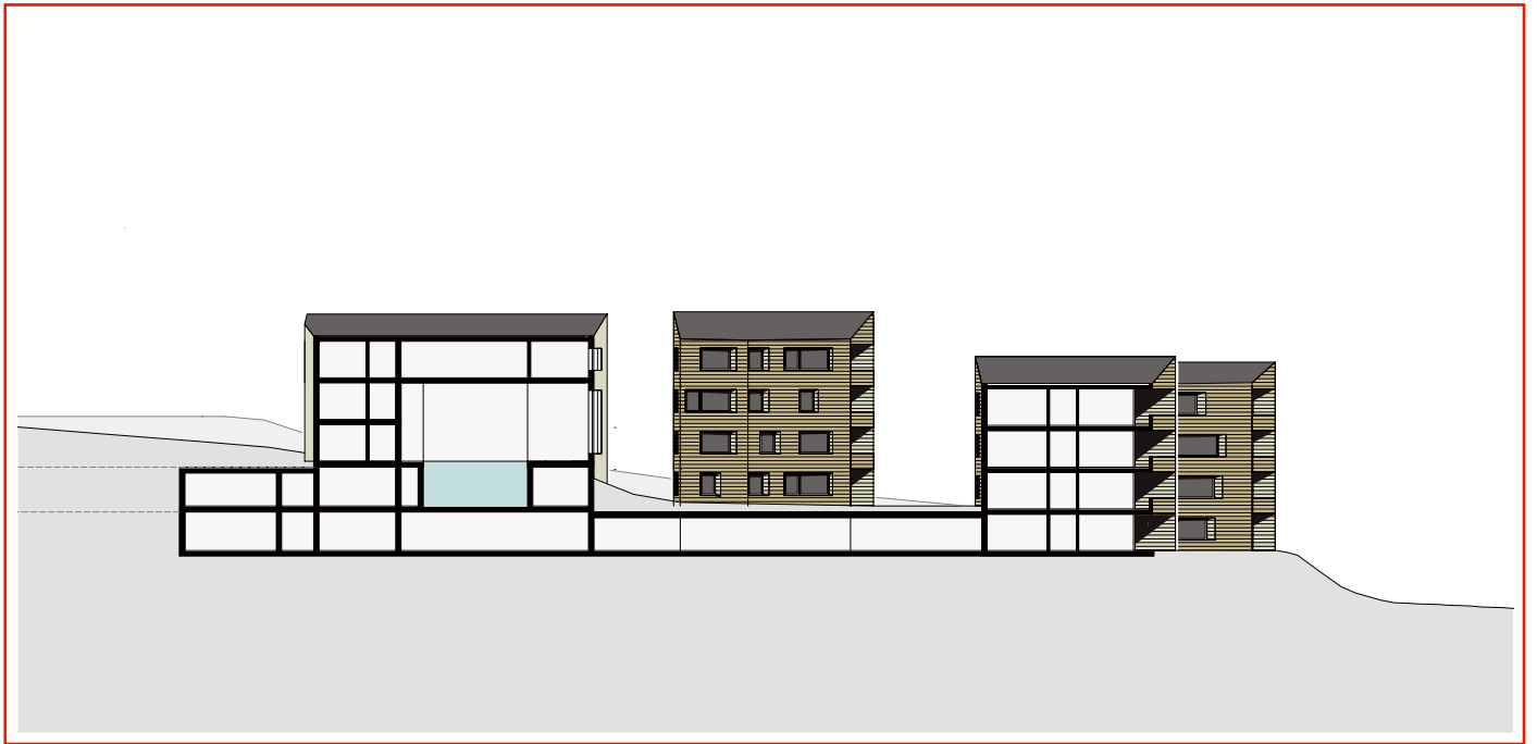
Schnitt Empfangshaus und Wohnhaus mit unterirdischem Parkhaus
